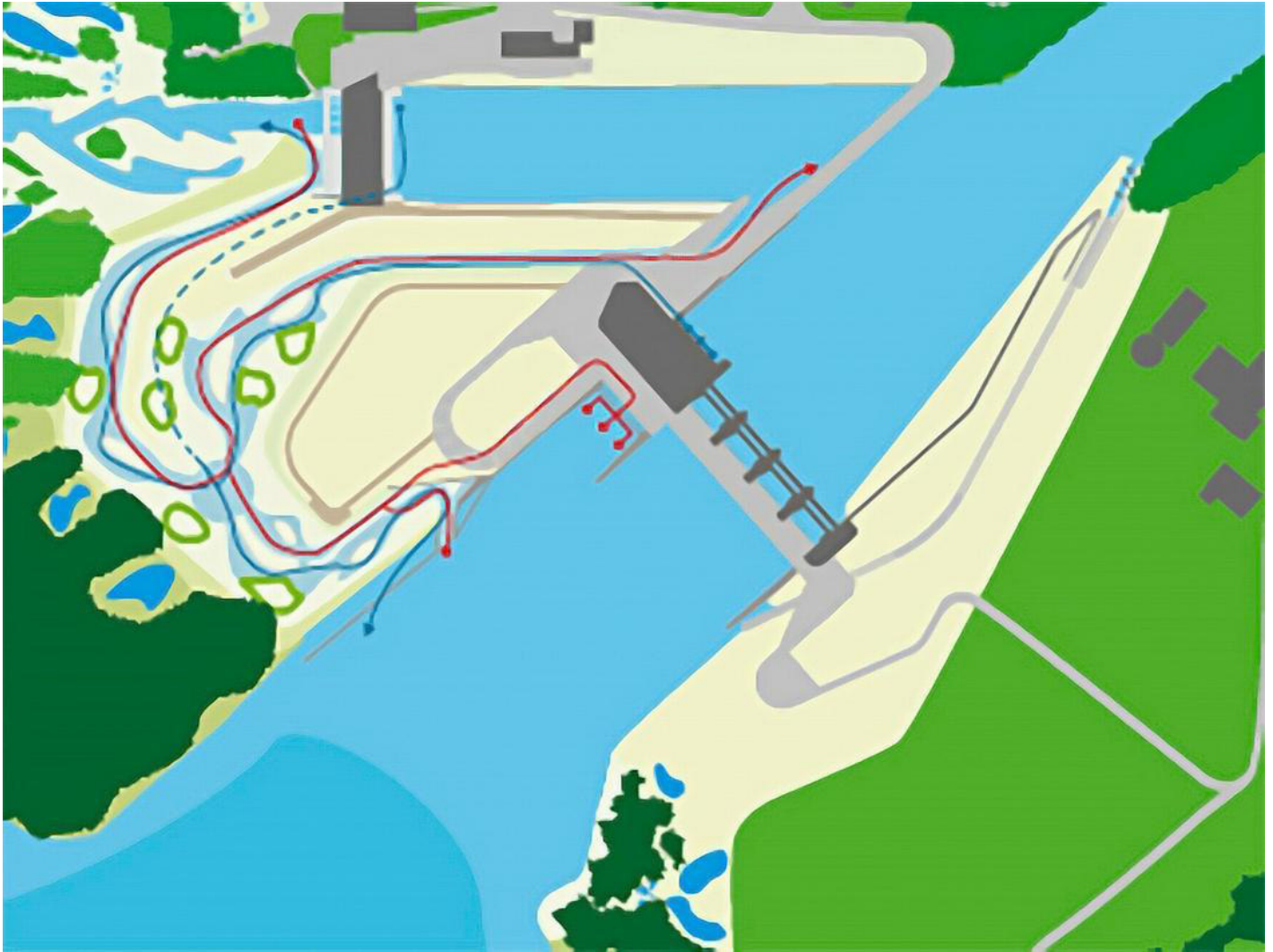
Bild BKW: Lockströmungen für die Fischtreppe Eindrücke vom alten Kraftwerk Hagneck I
